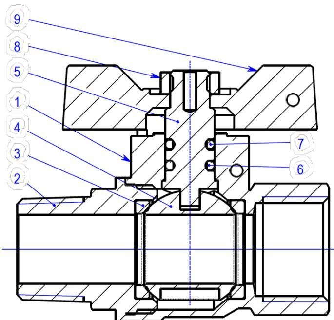
Кран состоит из составного латунного корпуса (поз. 1 и 2), затворного шара (4), который перекрывается с помощью рукоятки (9). Силу поворота рукоятки на шар передает шток (5) с двумя O-ring уплотнителями из эластомера NBR (6) и витона FKM (7). Рукоятка к штоку крепится с помощью гайки (8). Затворный шар размещается между седельными кольцами из тефлона (3).
